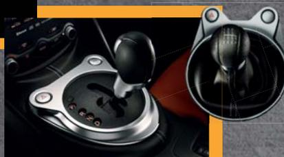
La transmission 6 rapports avec le nouveau système Synchro Rev Control vous fait bénéficier de changements de rapports extrêmement souples. Des capteurs sur l'embrayage et sur le levier de vitesse surveillent le comportement du conducteur afin d'augmenter le régime moteur ou prévenir toute chute de régime en cas de changements de vitesses. C'est la première fois que cette technologie est disponible sur une boîte manuelle.
