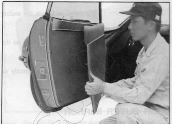
Fig. BF-26 Removing door finish
