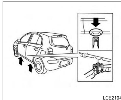
Mise sur cric du véhicule et retrait du pneu endommagé
