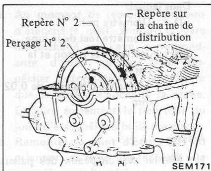
Remonter le guide de chaîne de distribution et le tendeur.
