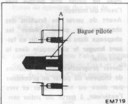
Lors du montage de la bague pilote, veiller à ne pas endommager la bordure de la bague et ne pas l'introduire trop profondément.
