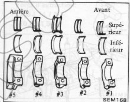
2. Remonter les coussinets inférieurs et serrer les boulons au couple indiqué.
