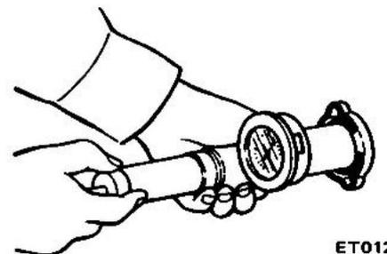
Fig. CO-5 Contrôle du bouchon de radiateur
