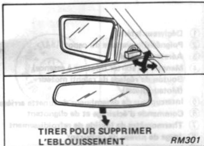
Ajuster la position des rétroviseurs intérieur et extérieurs avant de partir. La visibilité vers l'arrière doit être parfaite.
