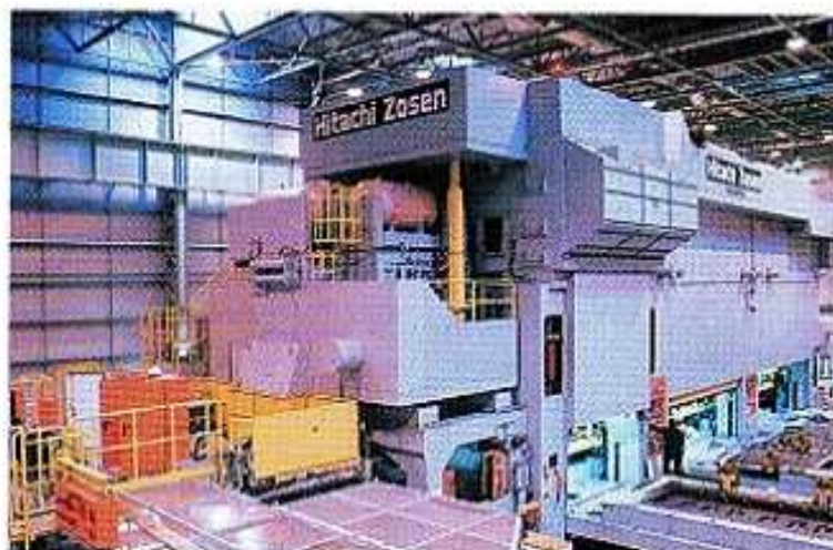
A côté. La presse de 5000 tonnes est la plus grande de ce genre au monde. A droite. Phase d'assemblage de la coque de la Micra.
