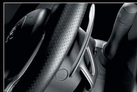
À vous de choisir entre un changement de vitesse entièrement automatique, prévu pour la conduite en ville ou en douceur, et un mode manuel, prévu pour les conditions de conduite plus extrêmes. En mode manuel, les palettes situées de chaque côté du volant vous permettent de passer d'une vitesse à l'autre très rapidement. Résultat : pas d'interruption dans les accélérations et une montée en puissance parfaitement harmonieuse.
