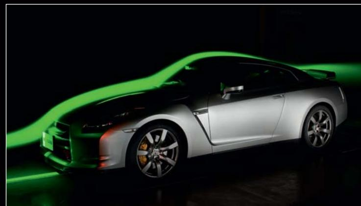
Avec un coefficient de pénétration dans l'air de 0,27 seulement, la GT-R s'impose comme l'un des véhicules les plus aérodynamiques du marché tout en bénéficiant d'un puissant effet de sol.
