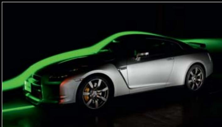
Avec un coefficient de pénétration dans l'air de 0,27 seulement, la GT-R s'impose comme l'un des véhicules les plus aérodynamiques du marché tout en bénéficiant d'un puissant effet de sol. Comme sur une voiture de course, ce phénomène d'effet de sol est ici accentué par le flux d'air qui circule de la baie moteur au diffuseur à travers le tunnel de transmission.
