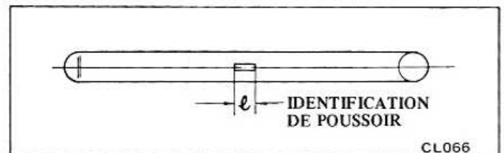
Fig. CL-13 Marque d'identification de poussoir (ou longueur)
