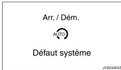
Ce message s'affiche lorsque le système Stop/Start ou le système d'arrêt au ralenti est défectueux.
