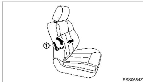
Déplacez le levier de réglage ① vers l'avant ou vers l'arrière pour régler la partie lombaire du siège, jusqu'à atteindre la position souhaitée.
