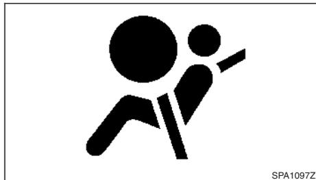
Le témoin d'avertissement d'airbag du SRS, s'affichant
