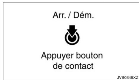
Les informations s'affichent et un témoin sonore se déclenche pour rappeler au conducteur de placer le contact d'allumage sur arrêt afin de ne pas décharger la batterie.
