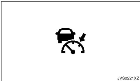
Lorsque le système ICC ne fonctionne pas correctement, le témoin sonore retentit et le témoin d'avertissement de système ICC (orange) s'allume.
