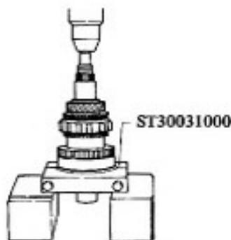
Fig. AT-75 Démontage des pignons d'arbre récepteur
