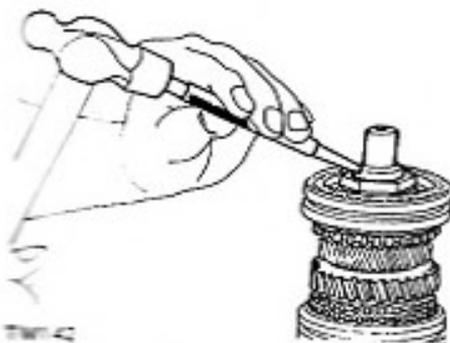
Fig. AT-83 Freinage de contre-écrou d'arbre récepteur
