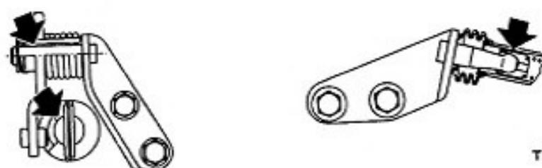
Fig. AT-46 Point de graissage du levier sélecteur et de la jambe de force
