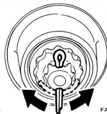
Fig. FA-4 Mise en place de la goupille fendue
