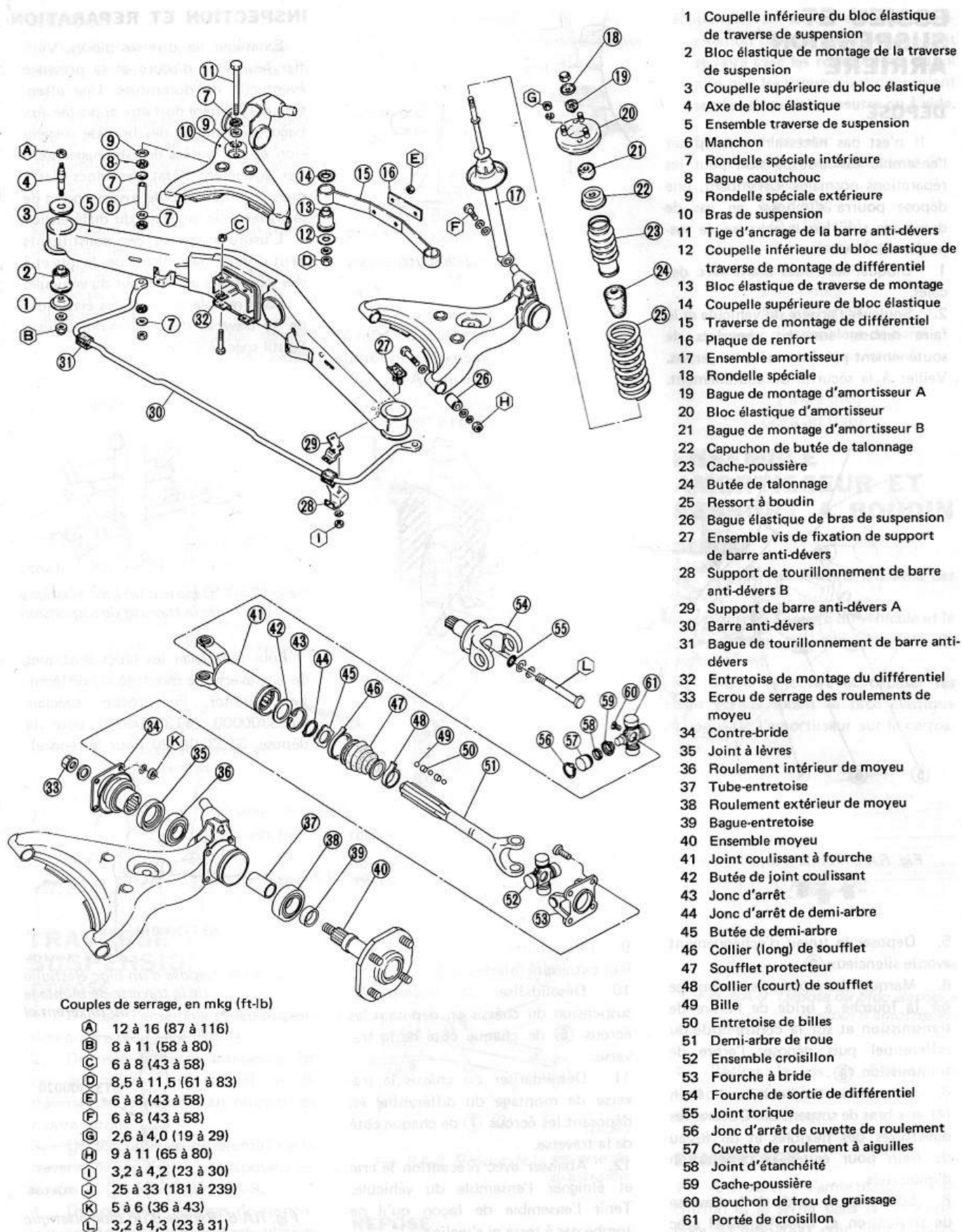
Fig. RA-1 Vue éclatée de l'essieu et de la suspension arrière
