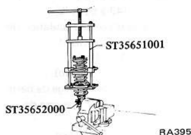
Fig. RA-10 Mise en compression du ressort
