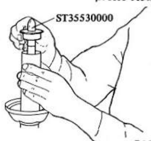
Fig. FA-21 Repose du presse-étoupe
