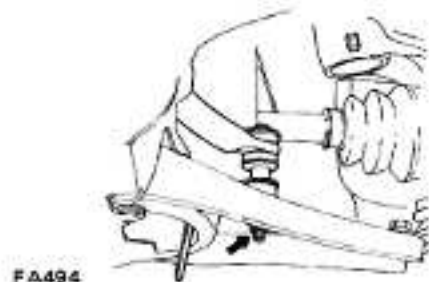
Fig. FA-39 Dépose de la barre stabilisatrice
