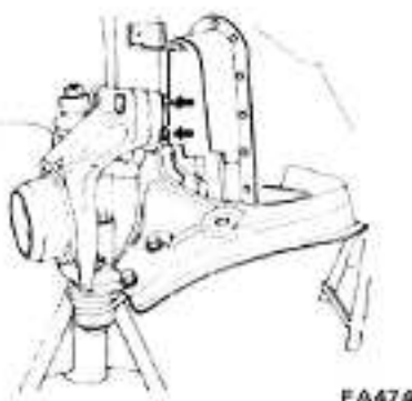
Fig. FA-7 Dépose du porte-fusée
