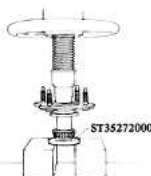
Fig. FA-16 Montage à la presse du roulement extérieur de moyeu
