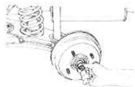
Fig. RA-3 Serrage à la main de l'écrou de fusée
