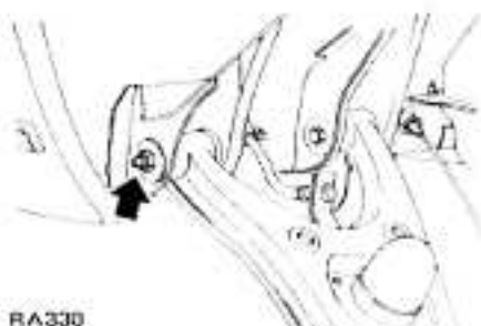
Fig. RA-15 Dépose du bras arrière
