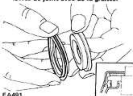
Fig. FA-35 Montage du joint de protection
