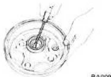
Fig. RA-6 Dépose de l'arrêt de graisse
