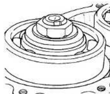
Fig. TM-23 Serrage de l'écrou de fixation de l'arbre primaire
