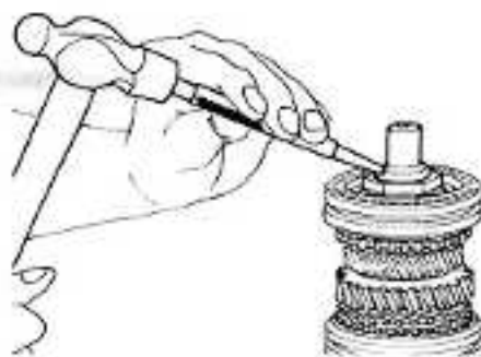
Fig. TM-26 Matage de la vis de blocage de l'arbre secondaire
