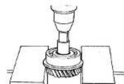
Fig. TM-6 Dépose du roulement du pignon récepteur d'arbre primaire
