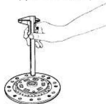
Fig. CL-6 Mesure de l'usure sur la garniture
