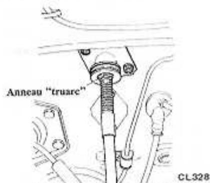
Fig. CL-4 Anneau "truarc" de réglage du câble de commande
